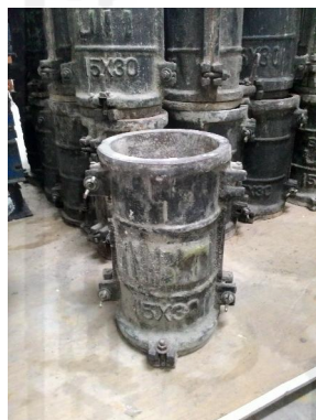
Gambar 4.4 Cetakan silinder beton
