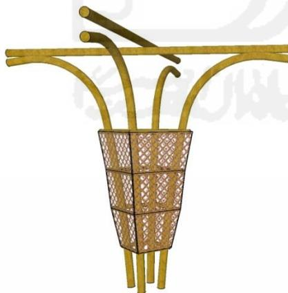
Desain kolom bangunan sebagai struktur yang terbuat dari batang-batang bambu memanfaatkan kelenturan maksimal bambu. Kombinasi dengan anyaman bambu sebagai ornament dari kolom bambu.
