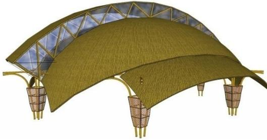
Desain atap yang terbentuk dari struktur cangkang dengan bahan material bambu memanfaatkan tingkat kelenturan bambu. Dikombinasikan dengan material kaca dan rumbai
