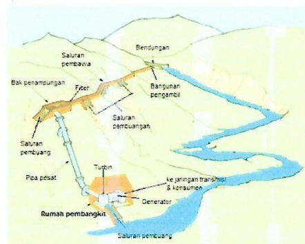
Gambar 2.1. Sistem PLTMH sederhana [4]
