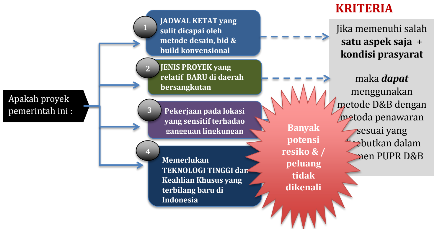
Gambar 3.8 Kriteria Kegiatan Konstruksi dengan metoda D&B (sumber: direktorat jendran bina konstruksi kementerian pekerjaan umum dan perumahan rakyat)
