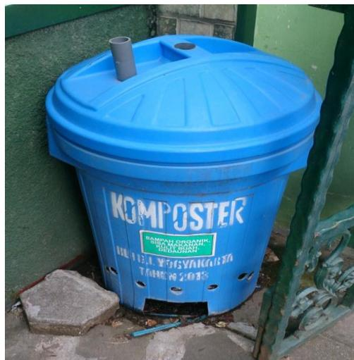
**Gambar 4.8 Contoh pengolahan kompos dengan kapasitas 20-30 Kg**
