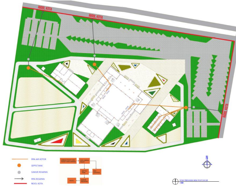
Gambar 5.12 Skema pembuangan limbah padat dan cair
