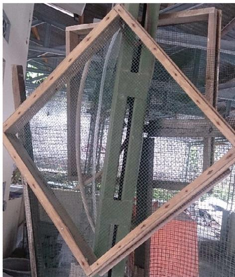
**Gambar 4.6 Saringan dengan Ukuran Lubang 4.75 mm**
