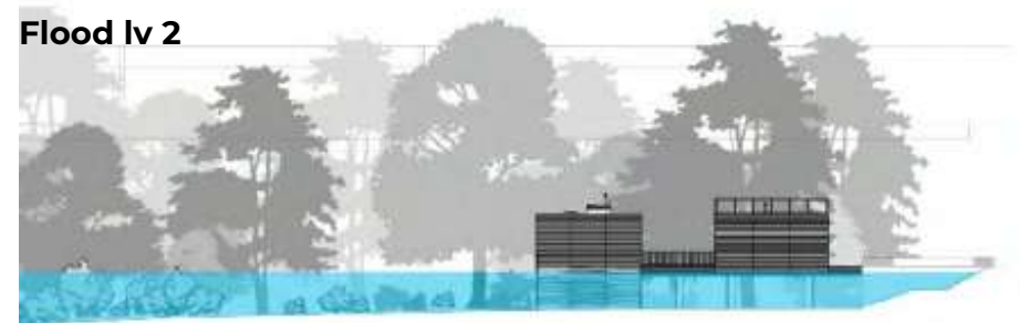
Gambar 2.19.2 Kondisi Bangunan Panggung Ketika Banjir
