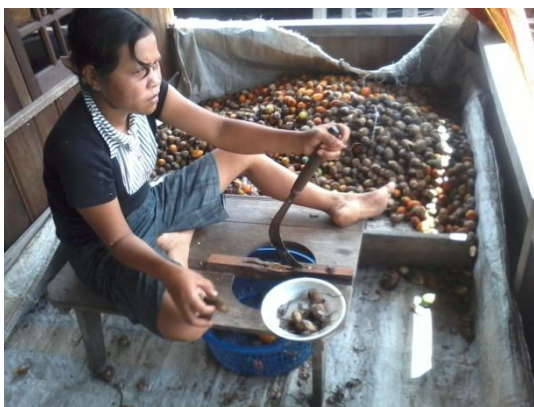
Gambar 5.2 Proses Pembelahan Buah Pinang Disan Alat Lama
