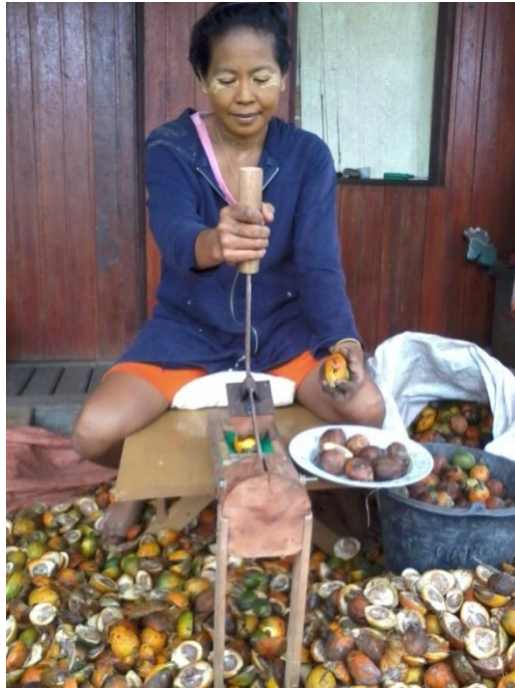
Gambar 10. Pekerja Melakukan Pembelahan dengan Alat Disain Baru
