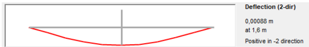
Gambar 5.35 Hasil Pengecekan Lendutan Batang 2 x IWF 700x300
