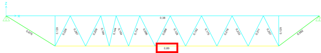
Gambar 5.18 Distribusi Rasio Kapasitas Elemen pada Arah XZ
