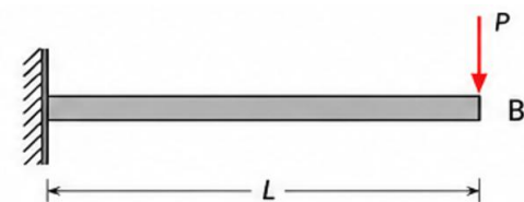
Gambar 3.5 Ilustrasi Balok Kantilever dengan Beban Terpusat di Ujung
