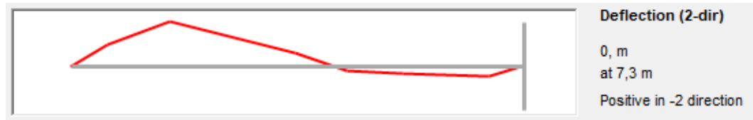
Gambar 5.48 Hasil Pengecekan Lendutan Batang 2 x H 300x300
