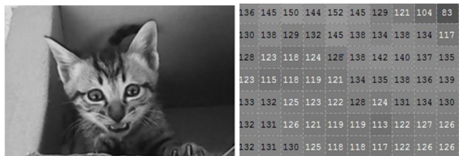
Gambar 3.7 contoh gambar (kiri) dalam bentuk grayscale , bentuk matriks dari contoh gambar (kanan).
