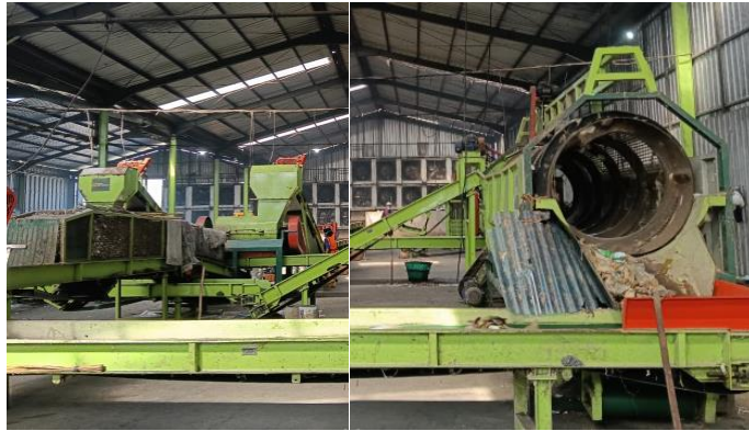
Gambar 4.11 Mesin Ayak dan Blower/Peniup
