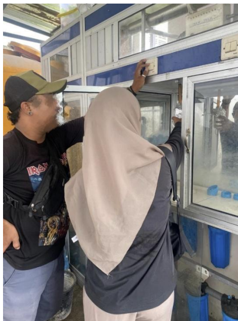
Gambar 3. 3. Pengambilan Sampel pada Mulut Kran Depot
