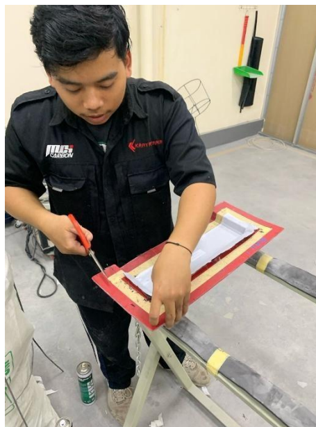
Gambar 4.4 Aktivitas lay-up serat karbon
