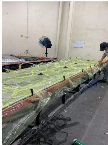
Gambar 4.5 Aktivitas proses vacuum infusion
