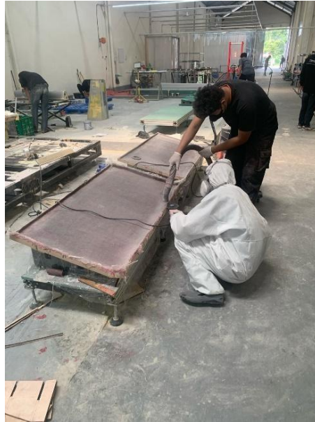
Gambar 4.6 Aktivitas proses trimming
