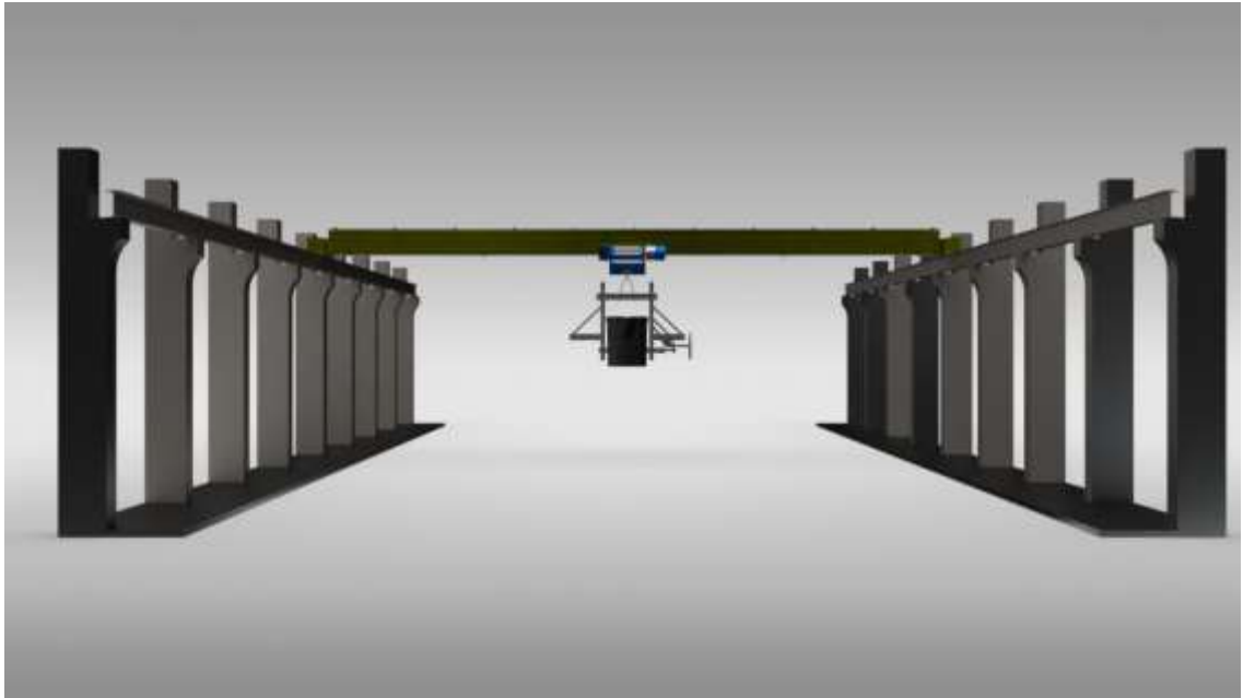
Gambar 4. 5 Desain Overhead Crane Tampak Depan
