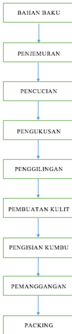
Gambar 4.2. Diagram Alur Proses Produksi Bakpia Djogdja
