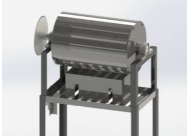
Gambar 4-2 Rancangan kedua rotary kiln reactor skala laboratorium
