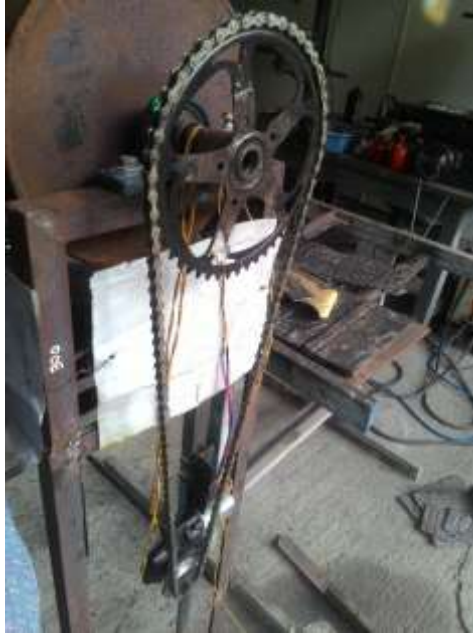
Gambar 4-6 Pemindah daya reaktor tipe rotary kiln
