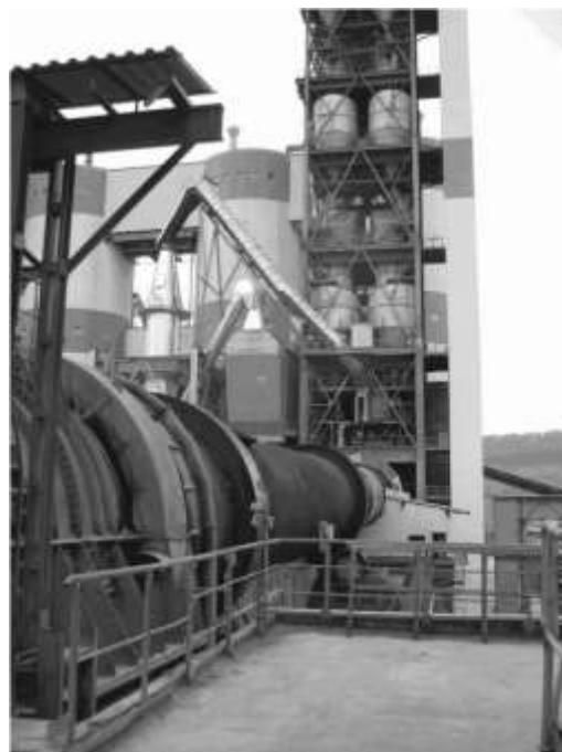
Gambar 2-5 Rotary kiln yang dilengkapi Preheater (Boateng, 2008)
