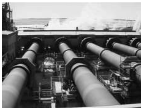
Gambar 2-4 Wet kiln untuk material setengah basah (Boateng, 2008)
