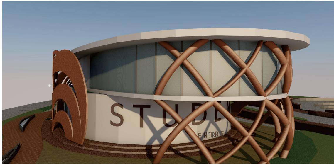
TIANG YANG BERFUNGSI SEBAGAI ESTETIKA DAN MENAHAN BEBAN STRUKTUR KECIL MATERIAL ALUMINIUM STAINLESS DIAMETER 30cm
