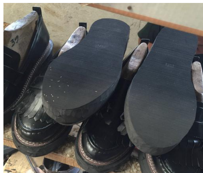
Gambar 5.1 Contoh Cacat Sol Sepatu Tidak Rapi
