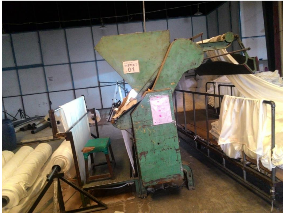
Gambar 3. Area Inspeksi mesin Inspeksi
