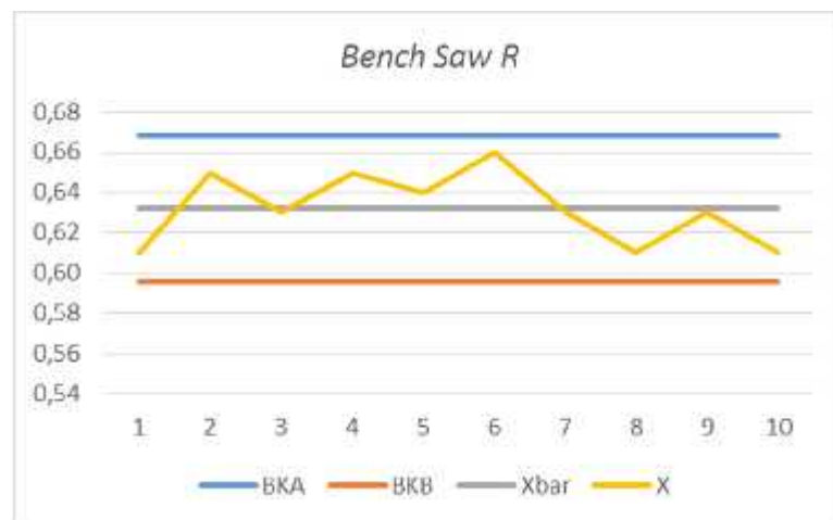
Gambar L. 5 Grafik Uji Keseragaman Data Proses Bench Saw R (Sumber : Hasil Pengolahan Data)
