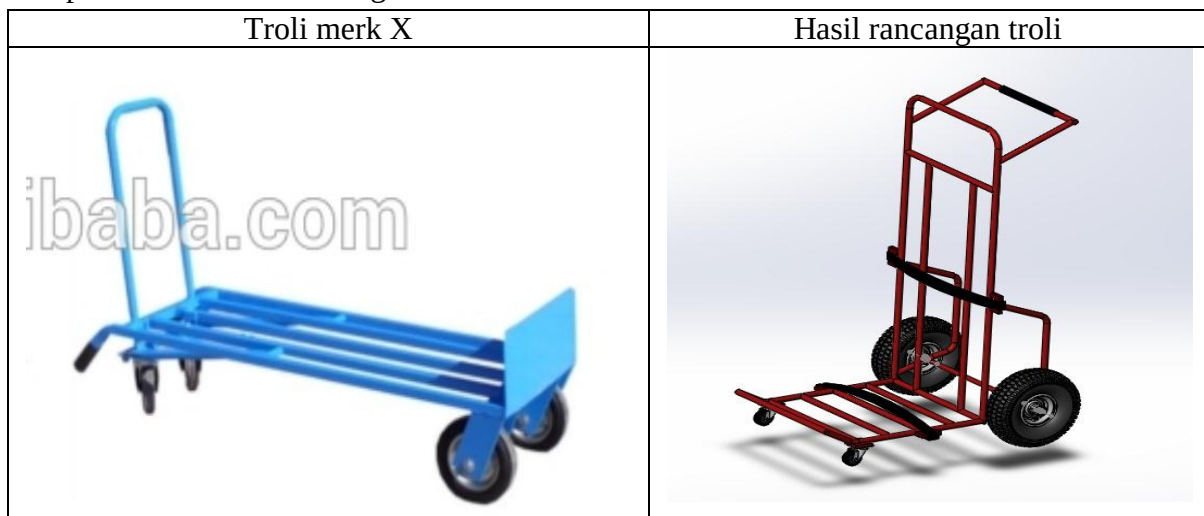
Gambar 4.26 Perbandingan troli merk x dengan desain troli usulan
