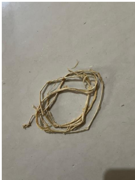
Gambar 4. 4 Serat Hasil Alkalisasi NaOH 10% Hari Ke-2
