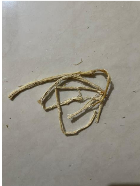
Gambar 4. 7 Serat Hasil Alkalisasi NaOH 10% Hari Ke-5
