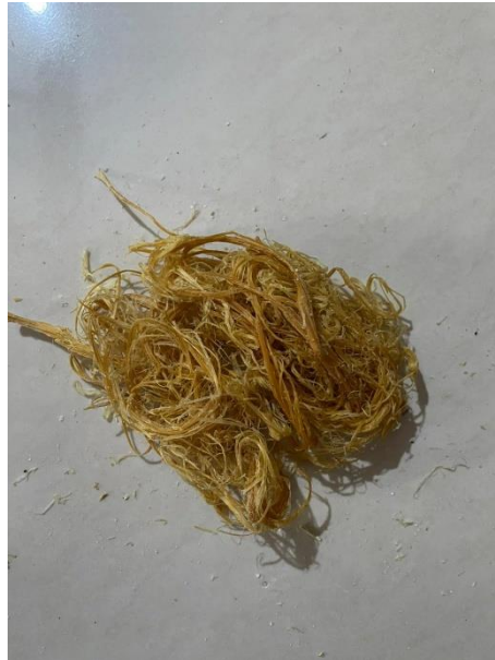
Gambar 4. 9 Serat Hasil Alkalisasi NaOH 10% Hari Ke-7
