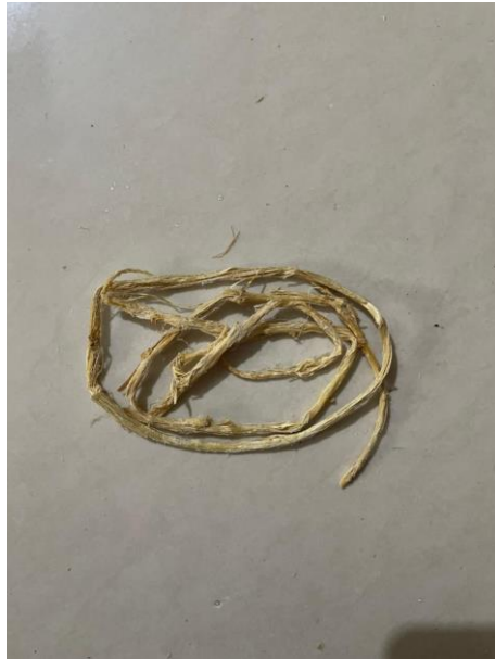
Gambar 4. 5 Serat Hasil Alkalisasi NaOH 10% Hari Ke-3
