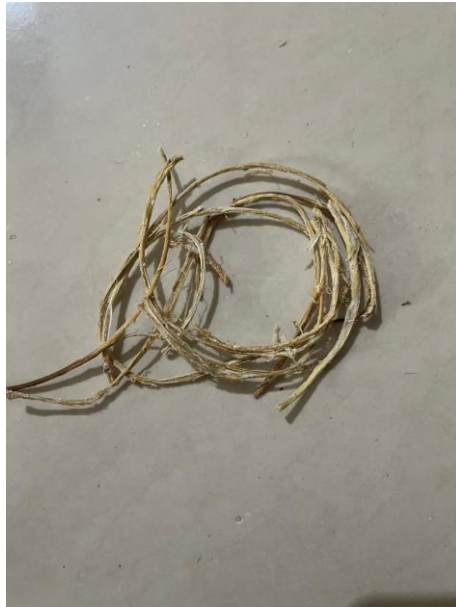
Gambar 4. 3 Serat Hasil Alkalisasi NaOH 10% Hari Ke-1
