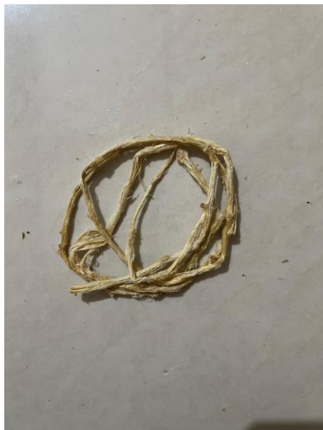
Gambar 4. 6 Serat Hasil Alkalisasi NaOH 10% Hari Ke-4
