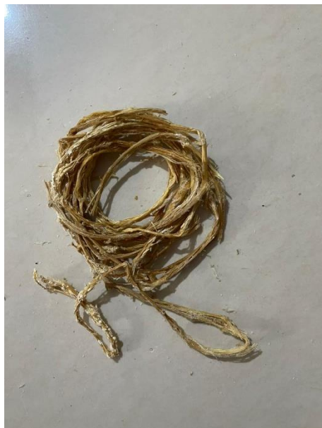
Gambar 4. 8 Serat Hasil Alkalisasi NaOH 10% Hari Ke-6
