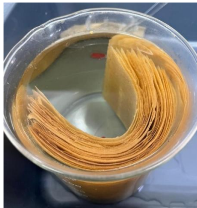
Gambar 4. 3. Proses Aktivasi Bio-Membran
