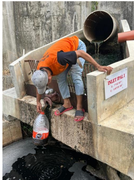
Gambar 4. 15. Proses Sampling Air Lindi Piyungan ( Inlate IPAL) Sumber: Dokumentasi Pribadi, 2026.
