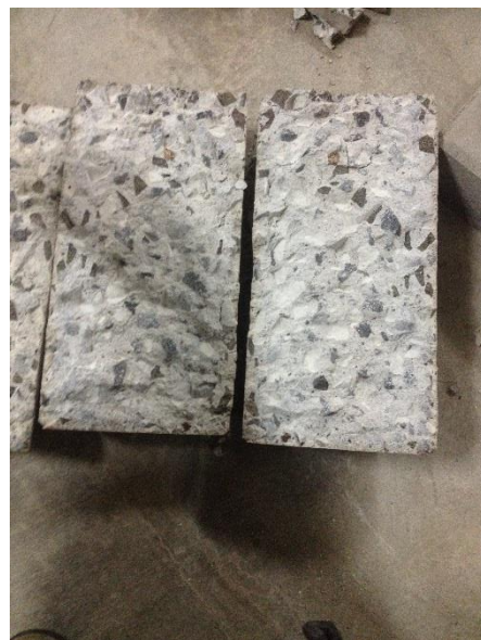
Gambar L-3.2 Beton Normal pengujian kuat tarik belah temperatur 500°C dan 600°C
