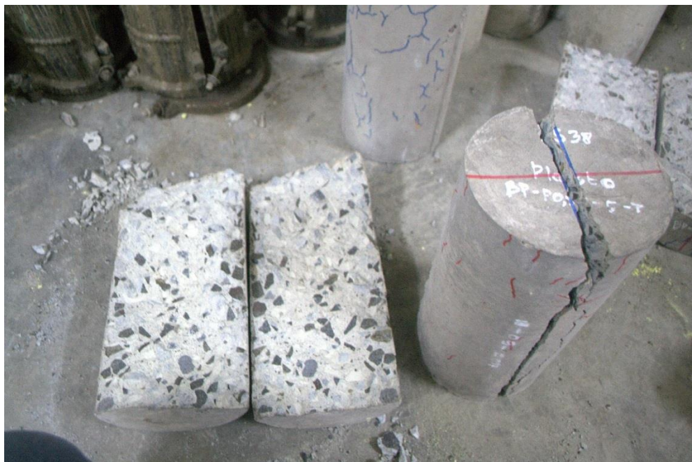
Gambar L-3.6 Beton Plastocrete ® RT6 Plus pengujian kuat tarik belah temperatur 500°C
