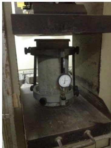
Gambar 5.22 Pengujian Tegangan-Regangan Beton
