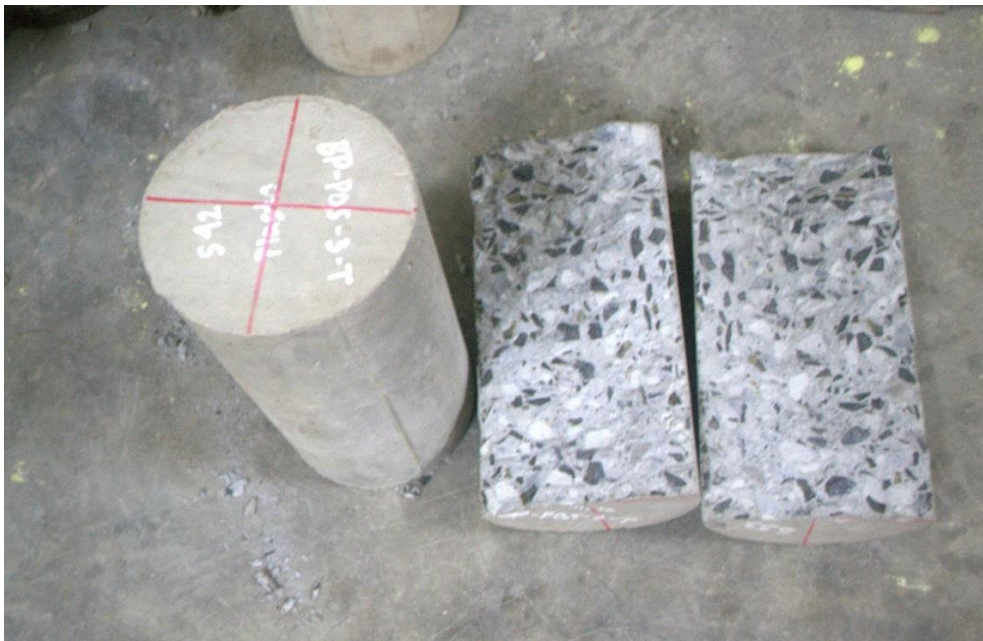
Gambar L-3.4 Beton Plastocrete ® RT6 Plus pengujian kuat tarik belah temperatur 300°C
