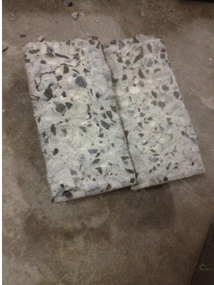
Gambar L-3.1 Beton Normal pengujian kuat tarik belah temperatur 300°C dan 400°C
