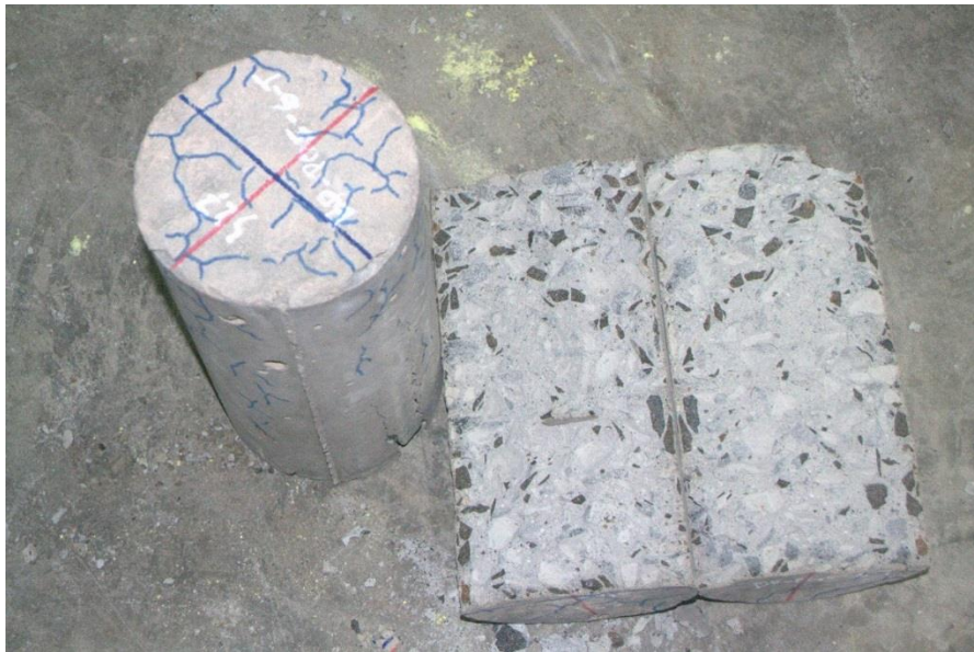
Gambar L-3.7 Beton Plastocrete ® RT6 Plus pengujian kuat tarik belah temperatur 600°C
