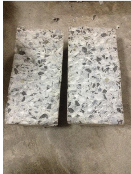
Gambar L-3.1 Beton Normal pengujian kuat tarik belah temperatur 300°C dan 400°C
