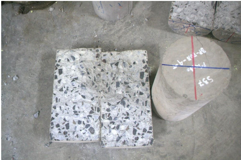
Gambar L-3.5 Beton Plastocrete ® RT6 Plus pengujian kuat tarik belah temperatur 400°C
