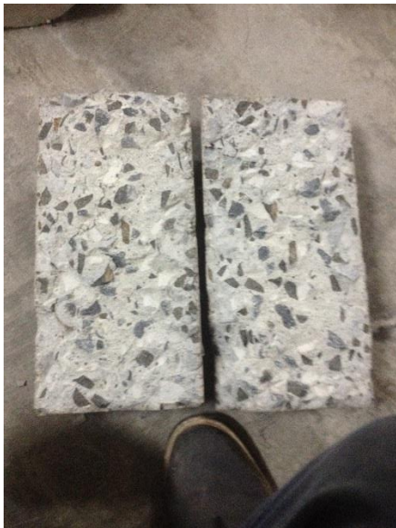
Gambar L-3.2 Beton Normal pengujian kuat tarik belah temperatur 500°C dan 600°C
