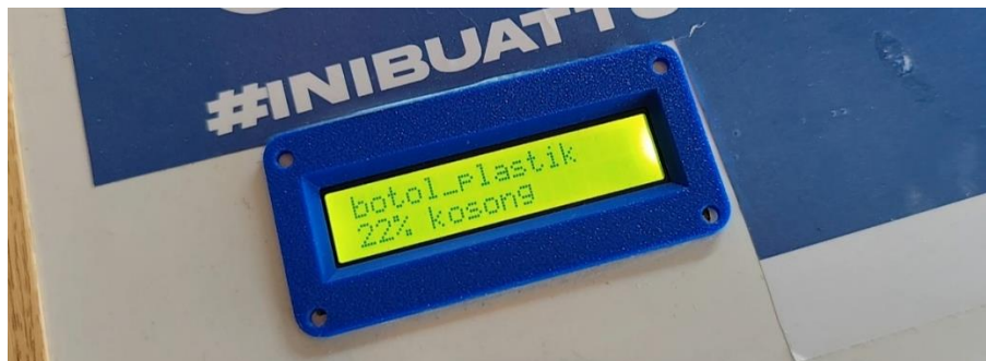
Gambar 4.18 Pengujian LCD ketika Sistem Berhasil Mendeteksi Sampah
