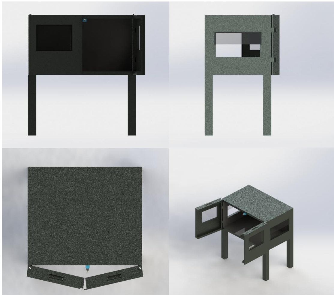
Gambar 5. 7 Usulan Desain Pintu Mesin Roll Brushing
