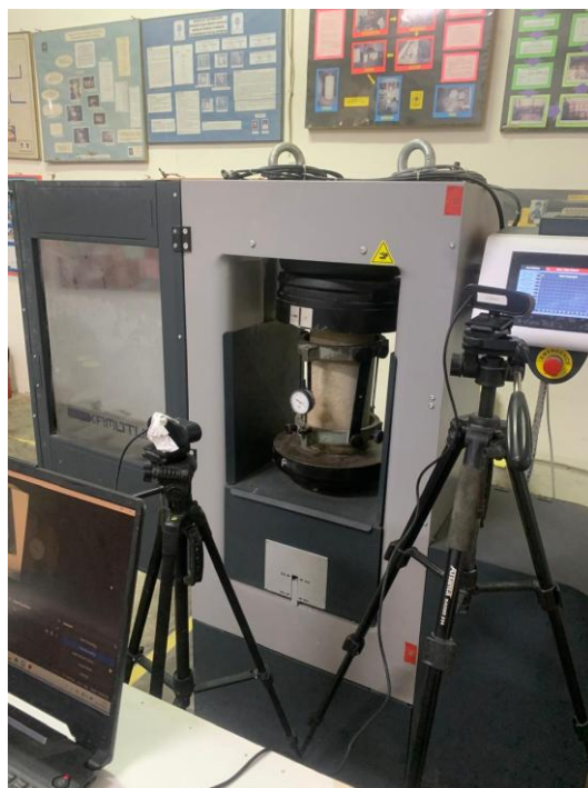
Gambar 7.6 Proses Pengujian Kuat Tekan dan Modulus Elastisitas Beton
