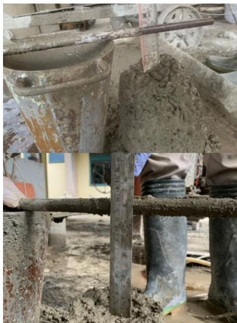
Gambar 7.2 Proses Pengujian Slump
