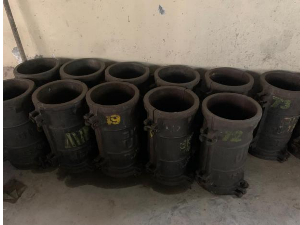
Gambar 8.3 Bekisting Benda Uji
