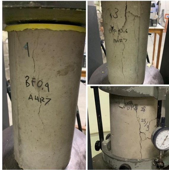
Gambar 7.7 Pola Keretakan Benda Uji Setelah Pengujian
