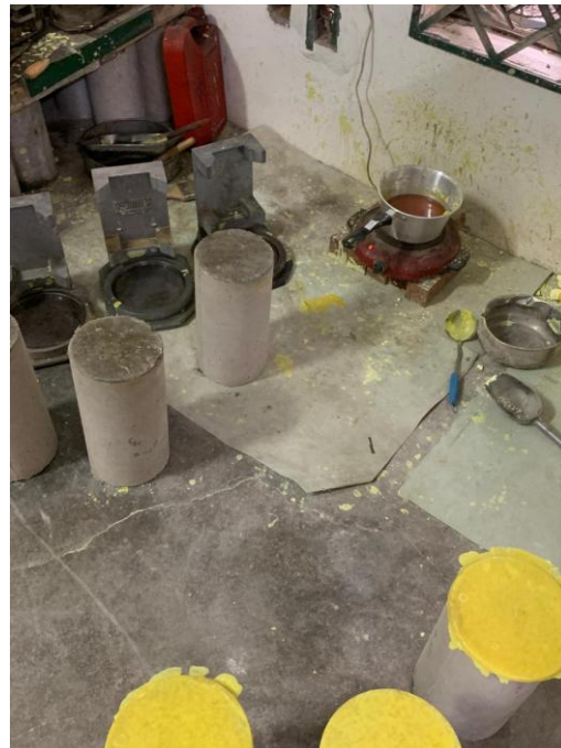
Gambar 7.4 Proses Pembuatan Capping
