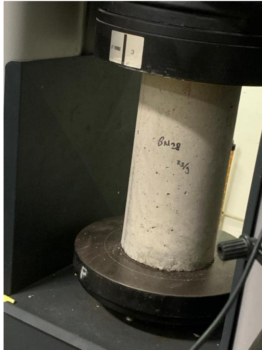
Gambar 7.5 Proses Pengujian Kuat Tekan
