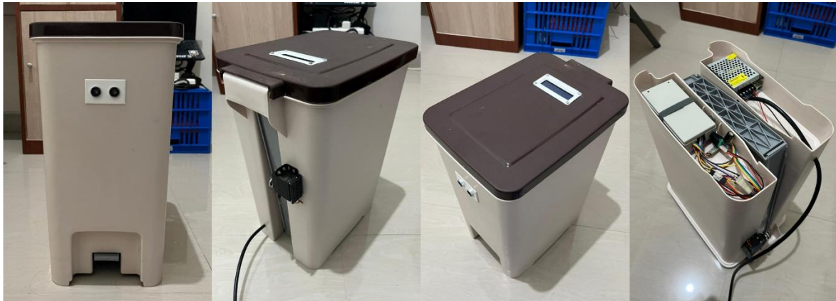
Gambar 4.1 Rancangan Sistem Tempat Sampah Cerdas
