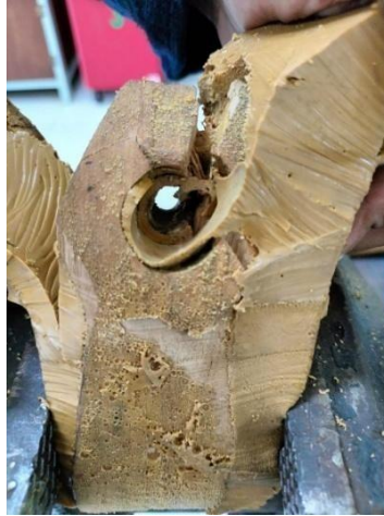
Gambar 4.35. Defect pada keel kayu jati.
