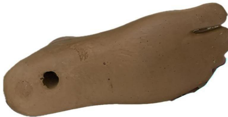
Gambar 4.23. Hasil produksi SACH (tampak bawah).
