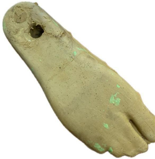
Gambar 4.33. Error produksi SACH keel kayu jati.
