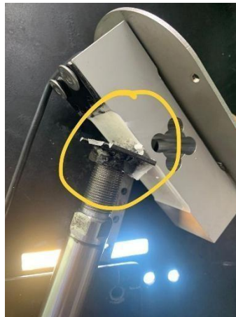
Gambar 4.36. Kerusakan load pada mesin uji fatik.
