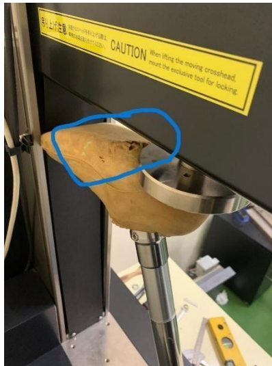
Gambar 4.34. Defect pada pengujian statik SACH keel jati.
