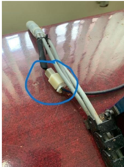
Gambar 4.32. Connector mesin CNC 3 Axis.
