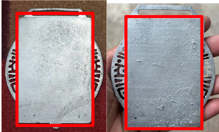
Gambar 4.27 Cacat Produksi Berupa Bidang Yang Tidak Merata
