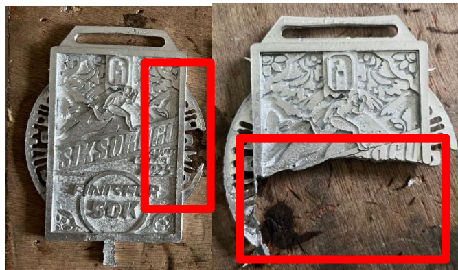
Gambar 4.25 Cacat Produksi Berupa Tidak Tercetak Secara Menyeluruh
