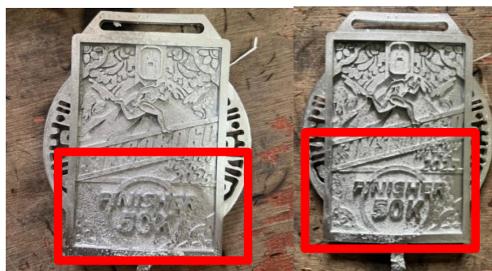
Gambar 4.26 Cacat Produksi Berupa Porositas
