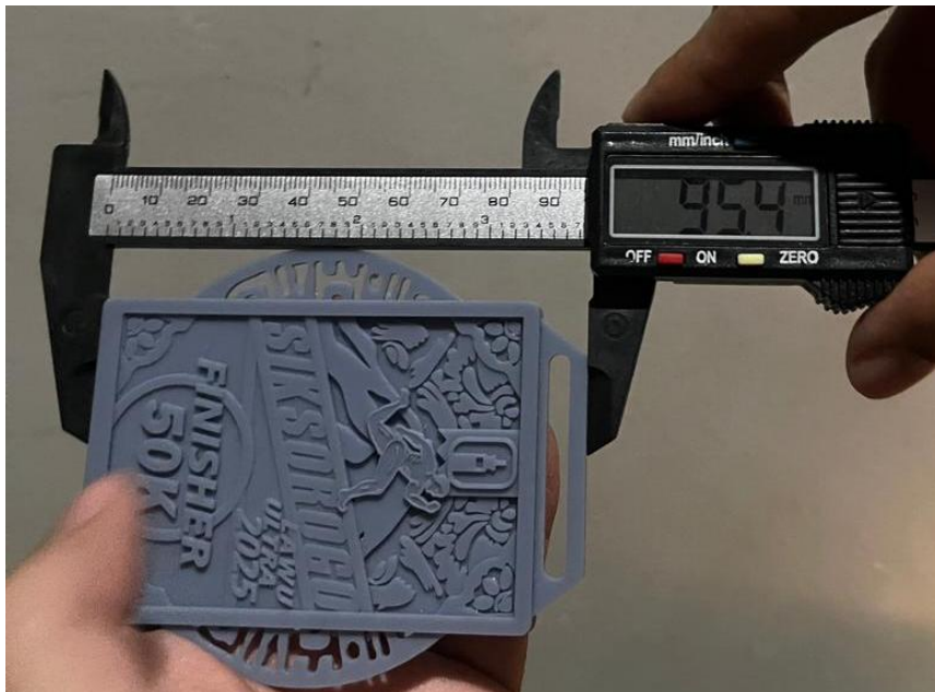
Gambar 4.15 Pengukuran Tinggi Master
