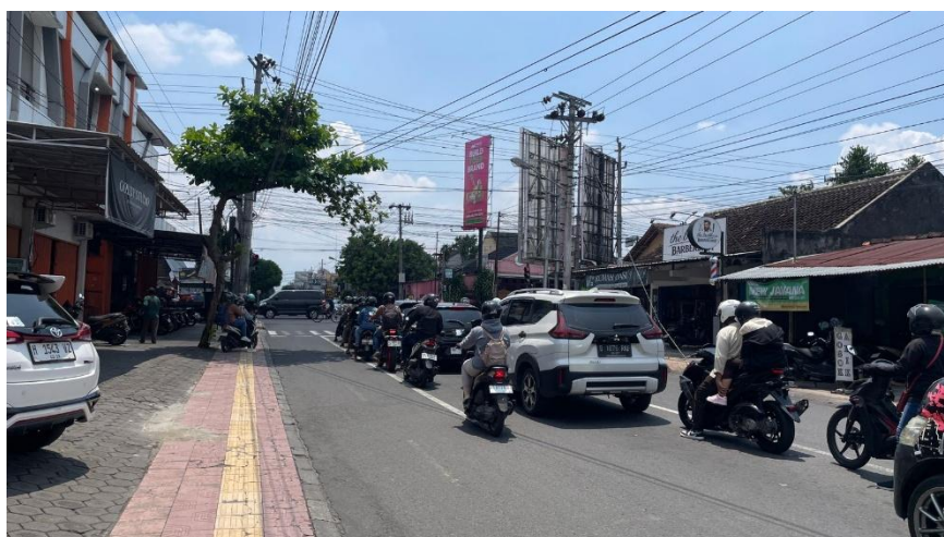
Gambar 5.10 Hambatan Samping Jalan Lowanu (Pendekat Selatan)
