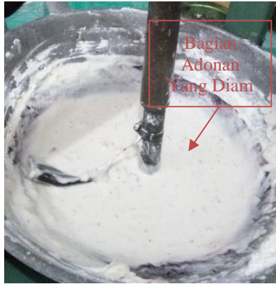
Gambar 4.4 Uji Prototype Pisau Pengaduk jenis blade paddle
