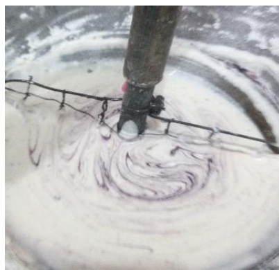
Gambar 4.2 uji prototype pengaduk jenis rangka besi
