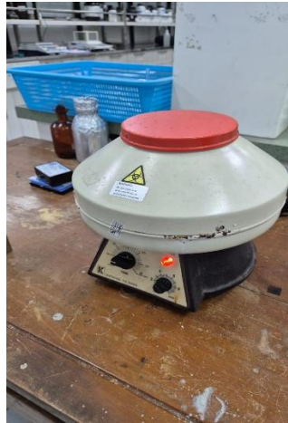
Gambar 3.8 Proses Pemisahan dengan Centrifuge
