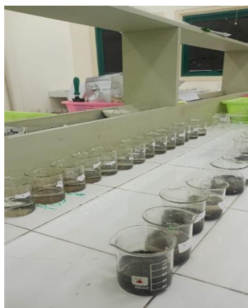
Gambar 3.9 Proses Penghilangan Bahan Organik Sampel
