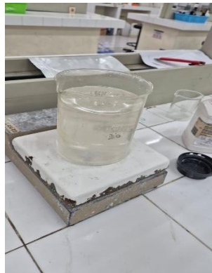
Gambar 3.7 Proses Pencampuran sampel dengan Larutan ZnCl_2
