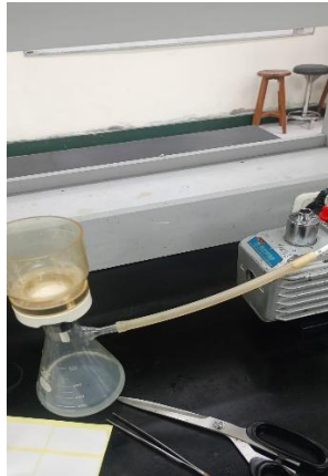
Gambar 3.10 Proses Penyaringan dengan Pompa Vakum
