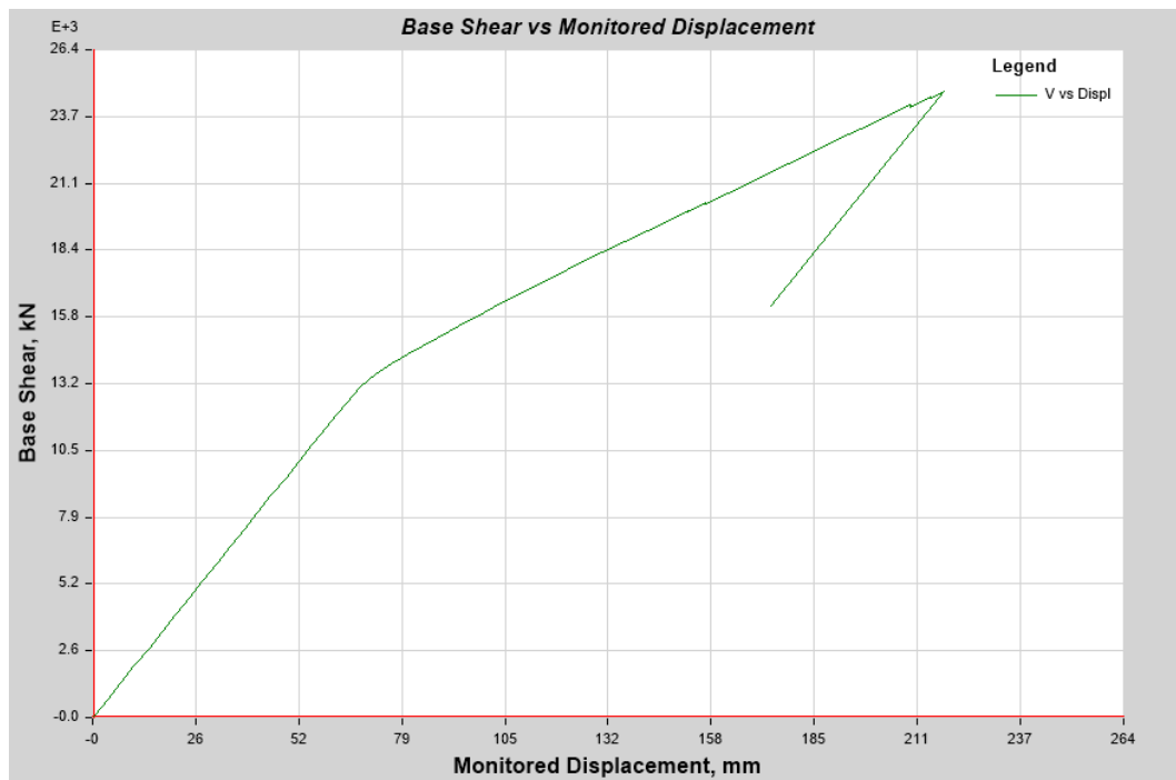
Gambar 5.57 Kurva Kapasitas Arah X dengan Variasi Kolom Persegi
