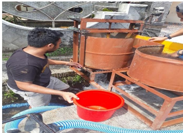
Gambar 3-8. Pengukuran debit menggunakan wadah.
