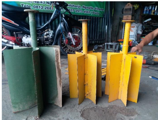
Gambar 4-22. Sudu turbin warna kuning yang sudah dipotong dan hijau belum di potong
