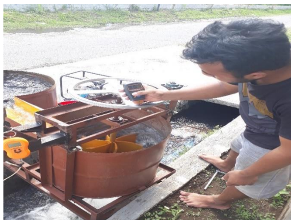
Gambar 3-9. Pengukuran putaran menggunakan tachometer.
