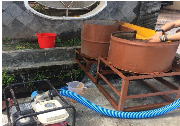
Gambar 3-7. Sistem masuk air ke bak penampung
