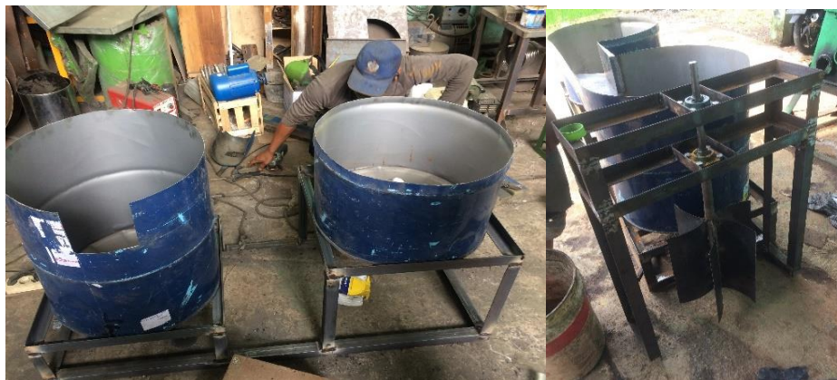
Gambar 4-1. Rumah Turbin, Bak Penampung dan Rangka
