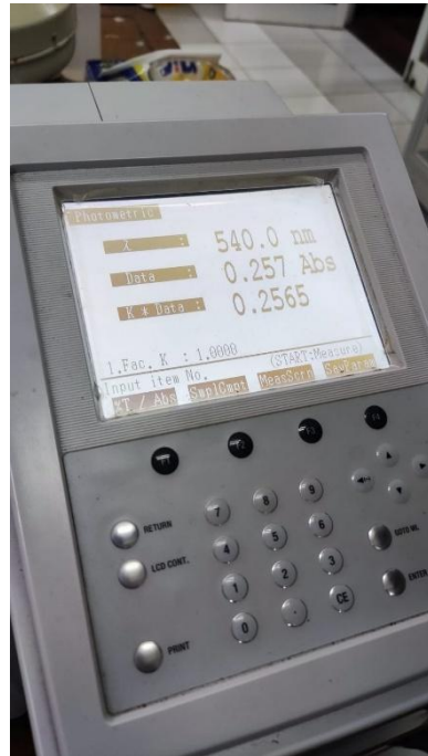
Pengukuran Absorbansi Sampel Udara Ambien
