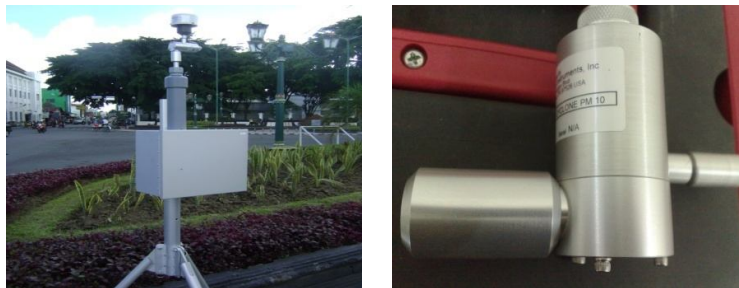
Gambar 3.4 Environmental Sampler (E-Sampler) dengan Ukuran 10 mikron
