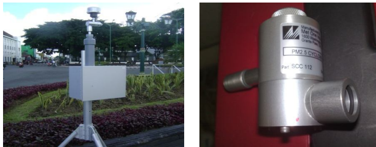
Gambar 3.3 Environmental Sampler (E-Sampler) dengan Ukuran 2,5 mikron
