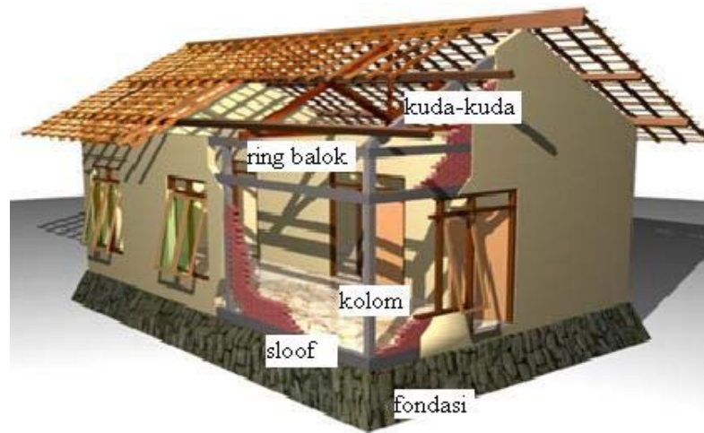
Gambar 1.1 Rumah tinggal dengan penerapan konsep-konsep rumah tahan gempa (Sarwidi, 2001).
