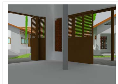
Gambar : Selain menggunakan jendela bukaan sebagai sirkulasi udara dan pencahayaan alami menggunakan kerawang (roster) pada dinding, sedangkan lantai menggunakan finishing ubin keramik ukuran 30x30 cm
