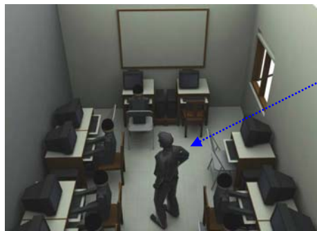
Gambar 6.15 : Bukaan/jendela yang cukup lebar pada muka ruang komputer dalam rumah singgah sebagai aliran udara (ventilasi silang) ke dalam ruang serta pencahayaan alami untuk menerangi ruangan
