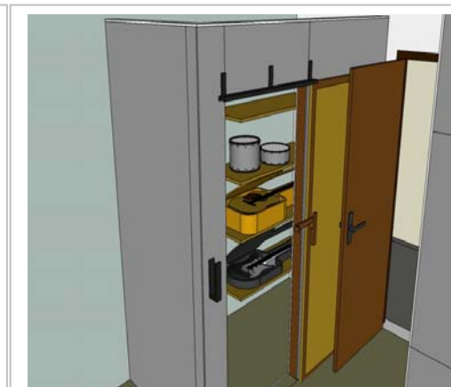
Gambar 6.25 & 6.26: Bagian dalam ruang penyimpanan alat musik dibuat rak bersusun yang terbuat dari material kayu, untuk meletakkan alat musik, seperti gitar, bass, dan alat perkusi lainnya.
