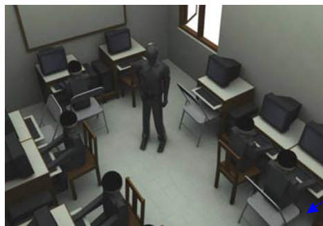
Gambar 6.15 : Bukaan/jendela yang cukup lebar pada muka ruang komputer dalam rumah singgah sebagai aliran udara (ventilasi silang) ke dalam ruang serta pencahayaan alami untuk menerangi ruangan
