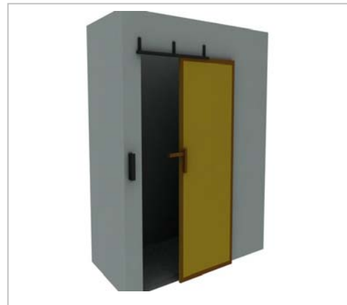
Gambar 6.24 : Ruang penyimpanan alat menggunakan material kalsiboard yang membungkus dinding rangka yang terbuat dari kayu. Dimensi ruang ( P: 2,1 m, L: 1m, T: 2,2 m )
