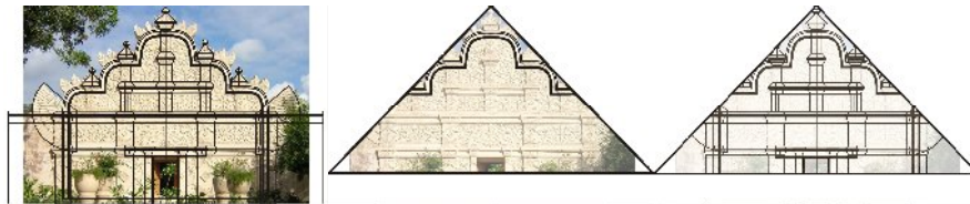
Gb. 3.3. Identifikasi Tipologi Gapuro Hageng, gapuro sebagai display lukisan alam, gapuro yang memiliki struktur balok dan kolom
