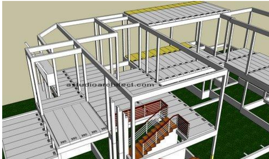
Gambar 4.10. Sistem Struktur Rangka pada bangunan
