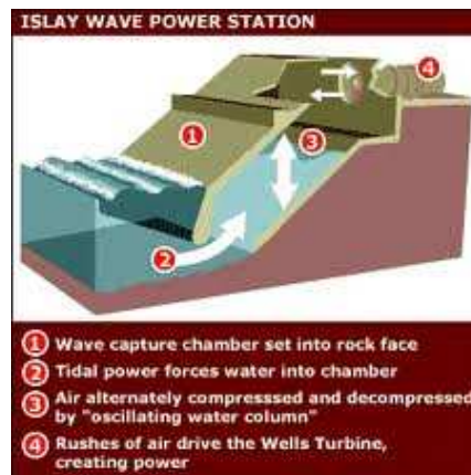
Gambar 2.38 Skema Prinsip Kerja Generator Energi Ombak 2 (sumber : http://alpensteel.com/energi_potensial_ombak?/jpeg12 )
