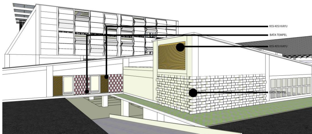
Gambar 5.1. 20 Selubung Bangunan Kantor Depok Sport Center Sumber: Analisis Penulis, 2017
