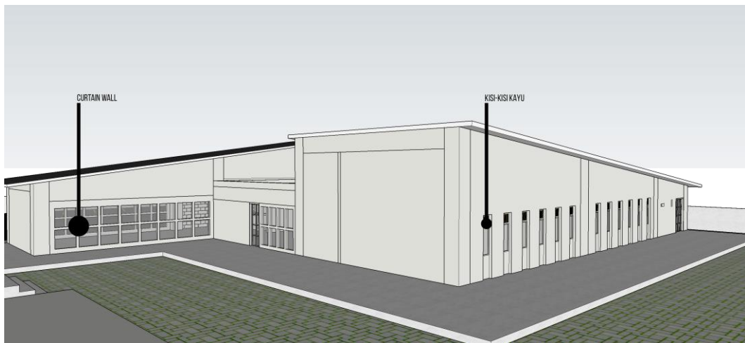
Gambar 5.1. 19 Selubung Bangunan Kantor Depok Sport Center Sumber: Analisis Penulis, 2017
