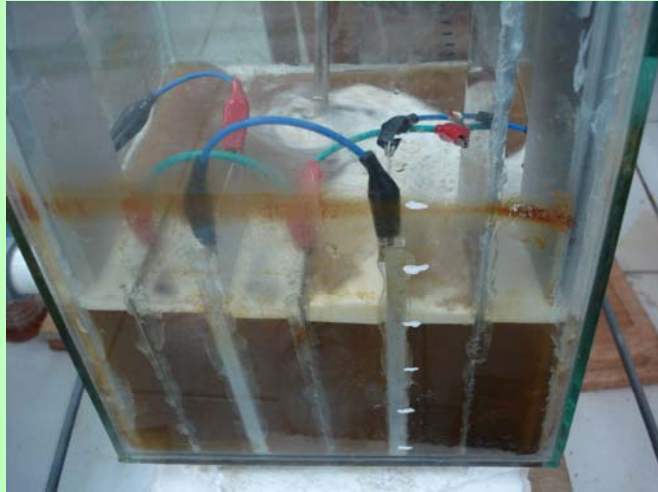
Proses Pengolahan Limbah Industri Batik Dengan Metode Elektrokoagulasi
