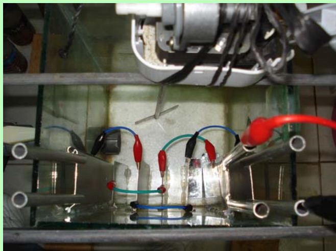
Alat Elektrokoagulasi Dengan Jarak Elektroda 3cm
