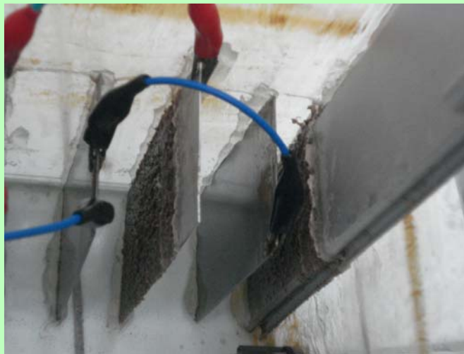
Lempengan Anoda Dari Stainless steel dan Lempengan Katoda Dari Aluminium
