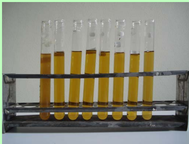
Hasil Penyaringan dan Perubahan Warna Dari Sampel Awal Dengan Waktu kontak Menit ke (5, 10, 15, 30, 45, dan 60) dan Pengadukan ke-60
