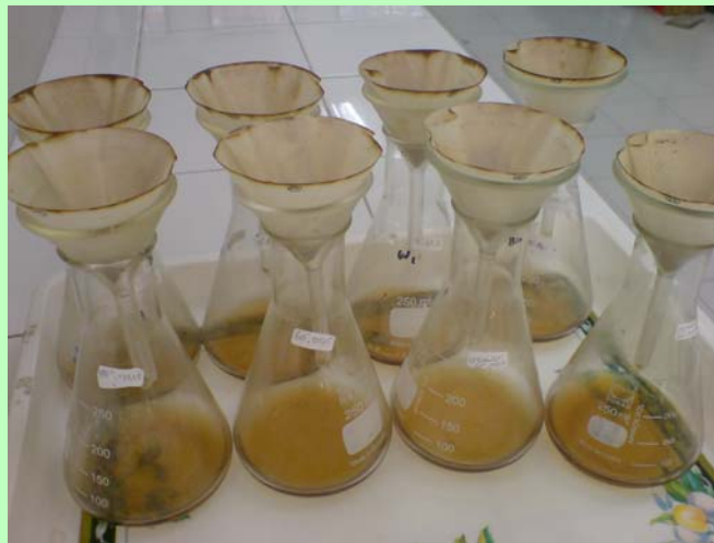
Proses Penyaringan Limbah Industri Batik Pengolahan Dengan Metode Elektrokoagulasi
