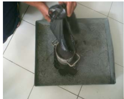
Penuangan Limbah Kedalam Silinder
