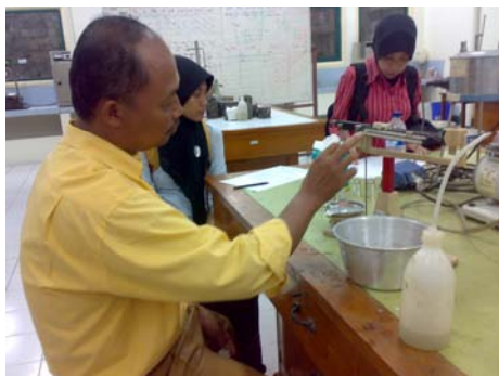
Penimbangan Picnometer dengan Air
