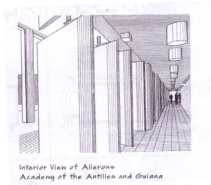
Gambar 2.26 Sirip bangunan yang bisa bergerak demi kepentingan pencahayaan dan penghawaan ruang bangunan.
