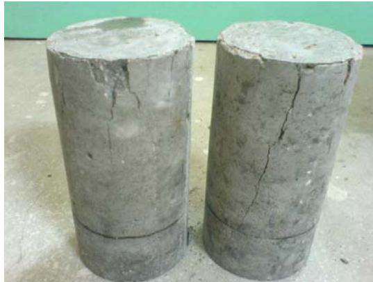
Gambar 5.1 Benda uji kuat tekan beton
