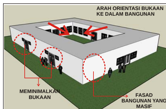
Gambar 5.5: Selubung Bangunan Griya Muslimah
