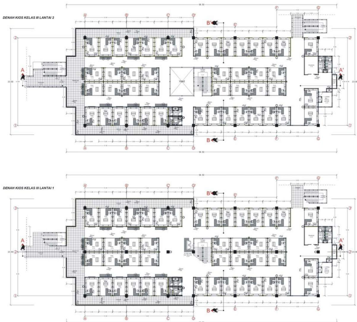
Gambar 5.8 Denah Lantai 1 Dan 2 Kios Kelas III
